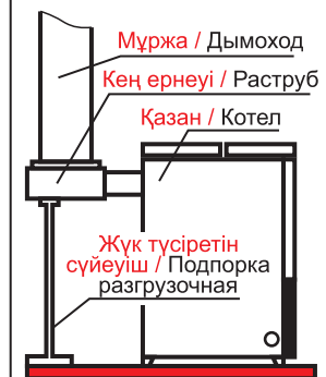
Рисунок 7. Схема соединения котла со стальной дымовой трубой
